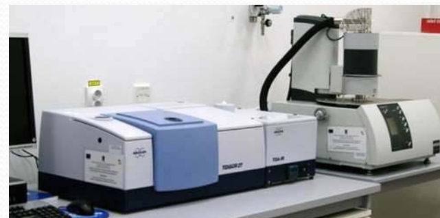
Spectrometru FT-IR cuplat cu sistem termic de analiza, Tensor 27, Bruker-STA F3 Jupiter, Netzsch
