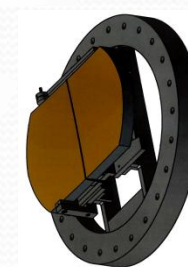
Oglinzi sistemului de reflexie multipla White, Bruker
