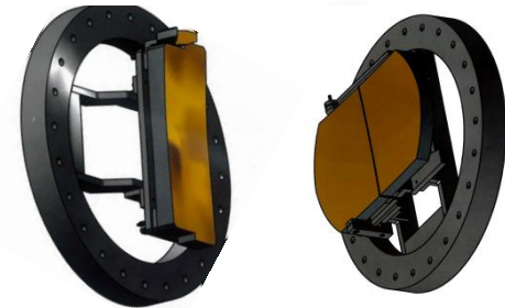
Oglinzile sistemului de reflexie multipla White, Bruker
