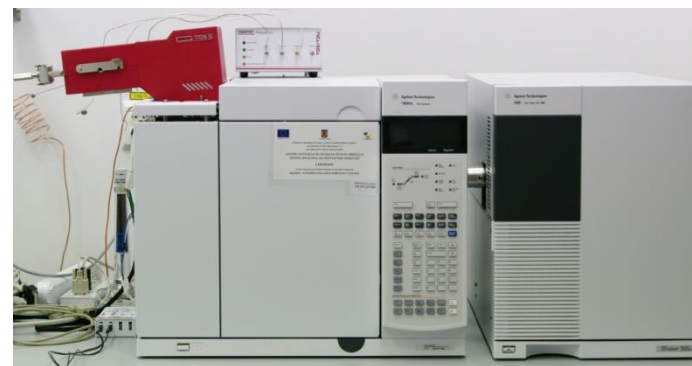
Cromatograf de gaze TDS-FID-MS Agilent
