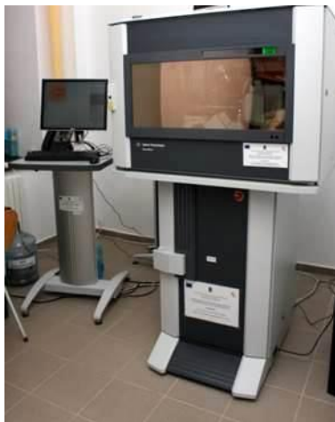
Difractometru de raze X SuperNova-Agilent
