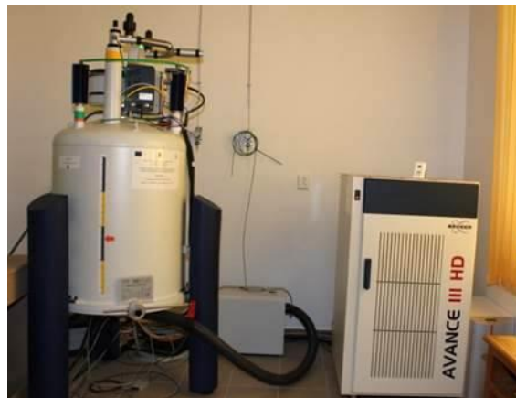
Spectrometru RMN 500 MHz Bruker
