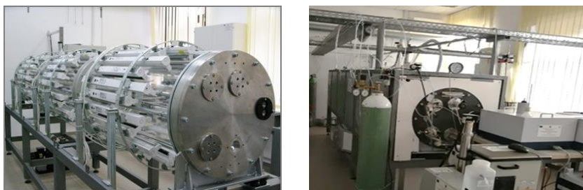
Figura I.17. Camera de reacție ESC-Q-UAIC și flanșa de admisie a camerei de reacție
