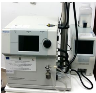
Figura I.21. Discriminatorul și numărătorul de particule SMPS-CPC (producător TSI, SUA)
