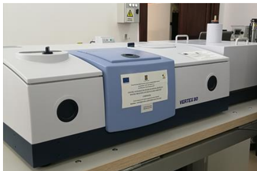
Figura I.20. Spectrofotometrul FT-IR de rezoluție înaltă Bruker, model Vertex 80
