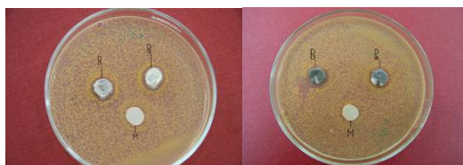
Figura 2. Rezultatele testelor antibacteriene utilizând Staphylococcus aureus ATCC 25923 (P1-Pb tratat cu sol de \text{AgNO}_3 , P2-Pa tratat cu \text{AgNO}_3 , P3-Pb schimbat ionic cu \text{Ag}^+ și redus cu \text{CH}_2\text{O} și P4-Pa schimbat ionic cu \text{Ag}^+ și redus cu \text{CH}_2\text{O} , M – probă oarbă)
