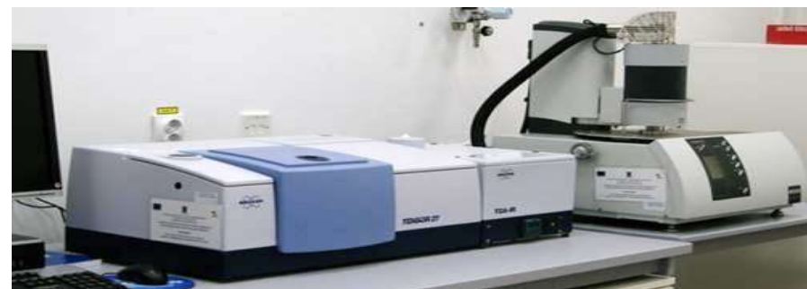
Spectrometru FT-IR cuplat cu sistem termic de analiza, Tensor 27, Bruker-STA F3 Jupiter, Netzsch
