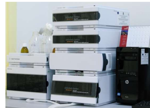
Lichid Cromatograf cu detectie multipla - Agilent
