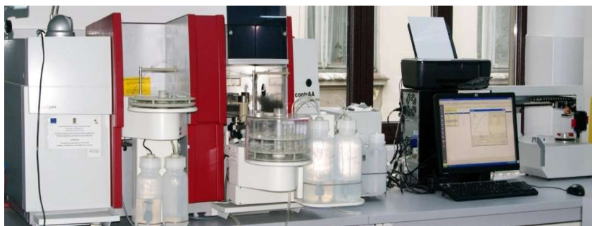
Spectrometru de Absorbție Atomică ContrAA 700 – Analytik Jena
